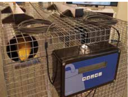
Het weegsysteem van Jasop volgt de gewichtontwikkeling tijdens de groeiperiode
