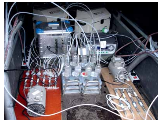
Aanhanger met meet apparatuur, hier ging de lucht naar toe voor direct meting of vullen van flessen
