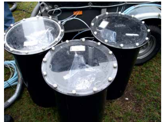
Luchtzakken die gevuld werden voor de geurmeting. De gevulde luchtzakken worden meteen naar Wageningen gereden
